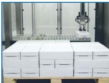
Die Vorrichtung kann zusätzlich mit einem automatischen Magazin und Palettenentnahme ausgerüstet werden. Darüber hinaus lässt sich die Maschine dank der Möglichkeit des Vorrichtungstandwechsels (Magazin für Paletten, Förder- / Auslaufbänder) in der Produktionshalle einfach platzieren.
